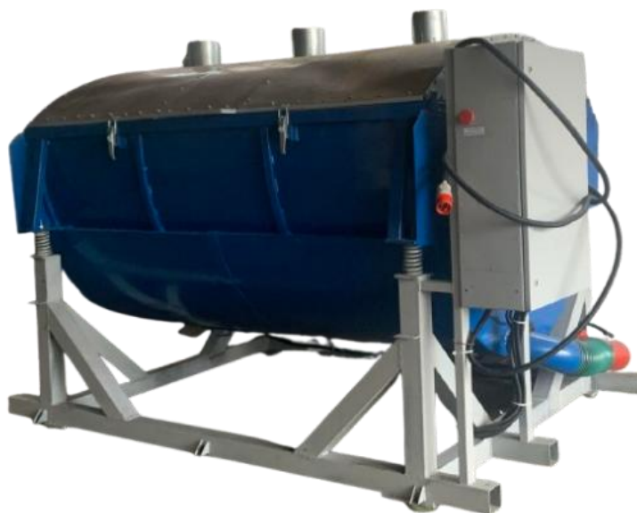
Рисунок 3.3 – Дослідно-промисловий зразок вібраційної машини для сушіння волоських горіхів
